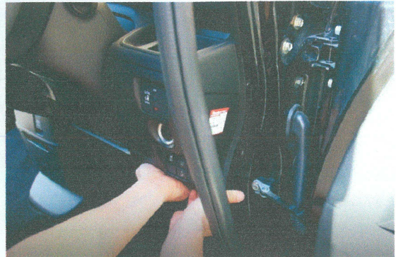
2. スタートボタン側からパネルを外します。 ※手で下側を持ち引っ張れば取れます。
