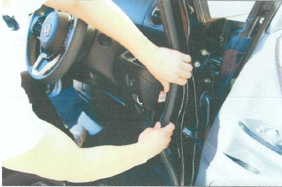
1. ウェザー ストリップを取り外します。 ※手で引っ張れば取れます。
